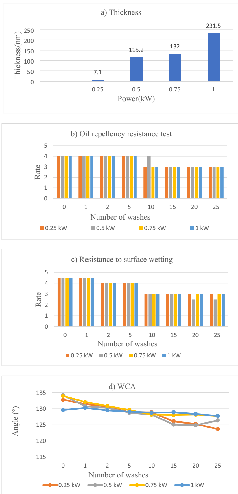
Fig. 2. Power effect (a) Thickness, (b) drop test, (c) spray test, (d) WCA.
